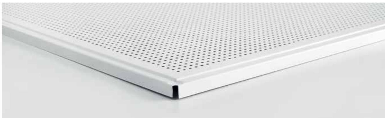
Bandejas conformadas por plegado, fabricadas con chapa de acero galvanizado prelacado de 0,50 mm de espesor. Todas las bandejas son suministradas con film adhesivo de protección.
