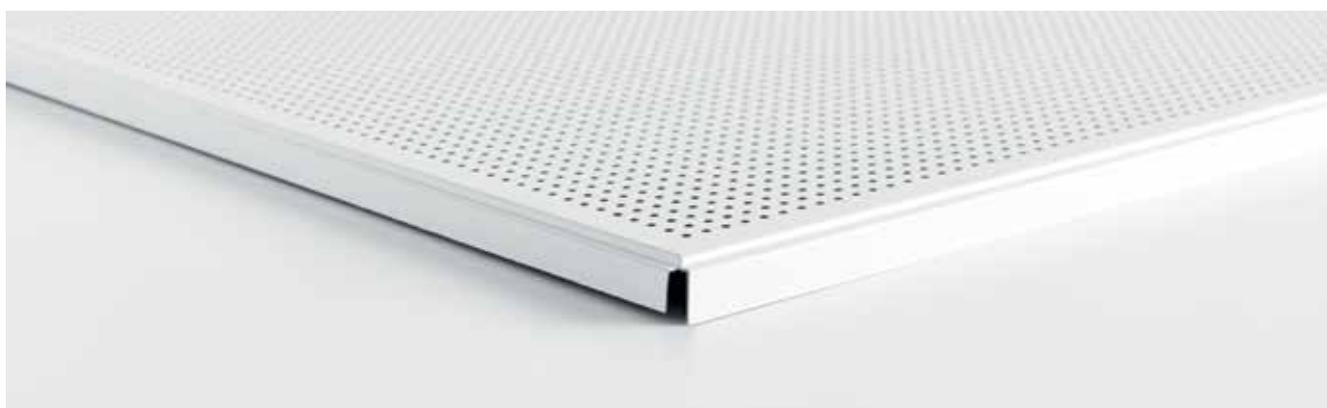
Bandejas conformadas por plegado, fabricadas con chapa de acero galvanizado prelacado de 0,50 mm de espesor. Existe la opción de fabricar las bandejas en aluminio de 0,60 mm de espesor. Todas las bandejas son suministradas con film adhesivo de protección.
