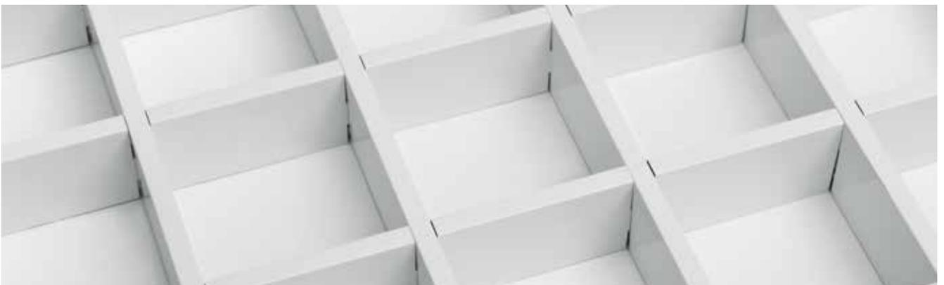
Rejillas fabricadas con aluminio prelacado de 0,40 mm de espesor más recubrimientos. Rejillas prelacadas en Poliéster con un espesor de capa de mínimo 20 micras en color Blanco y Silver (RAL 9006). Este tipo de acabado se caracteriza por una alta resistencia a la corrosión y durabilidad.
