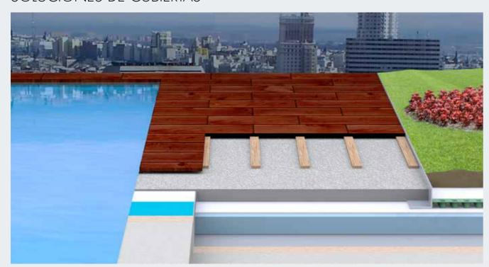
Que el tipo de cubierta sea invertida (aislamiento colocado sobre la membrana impermeable, al revés de la solución "convencional") responde a la necesidad de disponer del aislamiento térmico necesario con una cierta resistencia a la compresión que permita los distintos acabados, al mismo tiempo que se protege la lámina de las inclemencias del tiempo alargando su vida útil.
